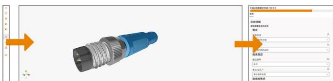
3D效果图根据右边的设置调整实时变化，也可以参考3D效果反过来更改设置
