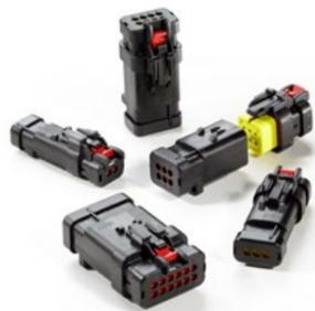
AMPSEAL 16 ハイブリッドレバーは、嵌合用のレバーライド機構とスライド式マウントクリップを備えた防水コネクタシステムです。最大で、16 サイズの端子 24 個と 12 サイズの端子 4 個の組み合わせが可能。様々な車載用途に対応した、フレキシビリティの高い設計です。
