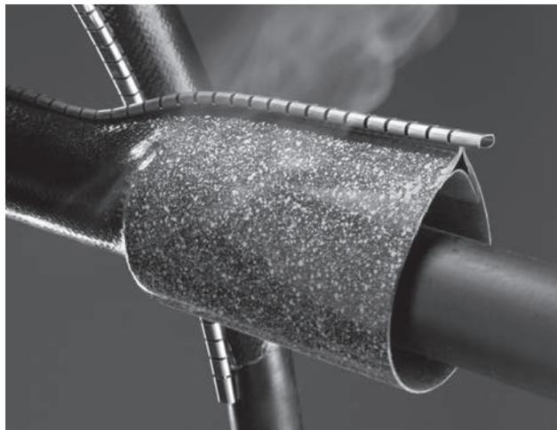
RFSM には、繊維強化複合材料ラミネートが使用されており、外面には、施工時の収縮を均一にするために、感熱性の塗料が塗布されています。さらに、レールの平坦面に取り付けの目安となる白線が塗られています。スリーブには、ホットメルト接着剤がプレコーティングされ、ケーブルに対し密着します。
