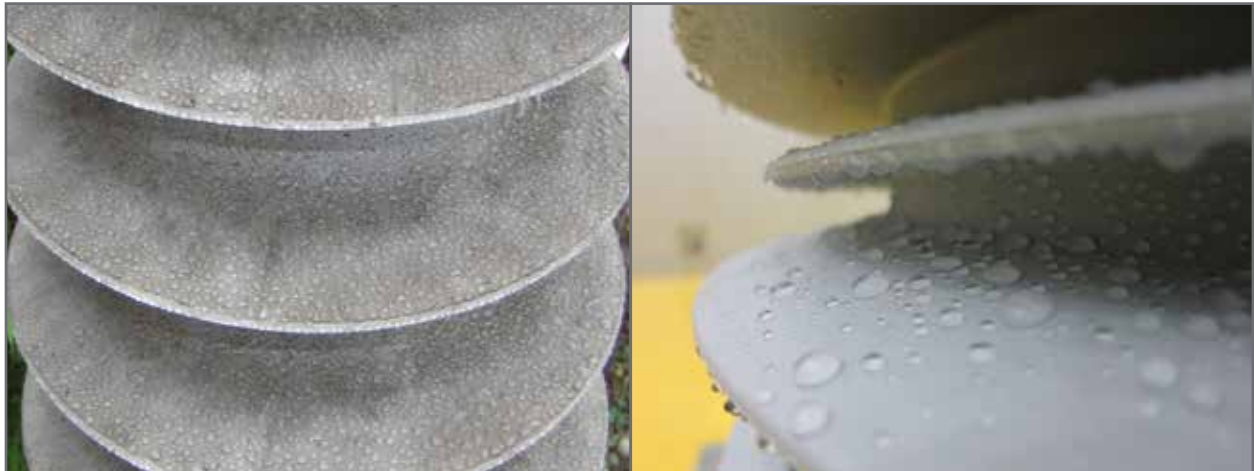
高汚染環境におけるAxicom ポリマーがい子 – 疎水性に有効 – 大雨条件下での誘電テスト中のAxicom ポリマーがい子疎水性の実証
