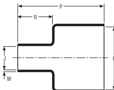
208R066 - Formteil zur Abdeckung an einem Ventilableiter, Haube nach unten offen
