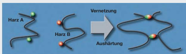
Bild 1 Schematische Darstellung der Reaktion bei GUROFLEX-N
