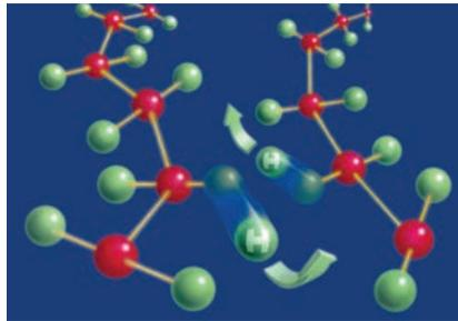
Die Forschung im Bereich der Bestrahlung chemischer Stoffe führte zu der Entdeckung, dass bestimmte Thermoplaste unter dem Einfluss energiereicher Elektronenstrahlung durch Abspaltung von Wasserstoffatomen chemische Bindungen zwischen benachbarten Molekülen herstellen.
