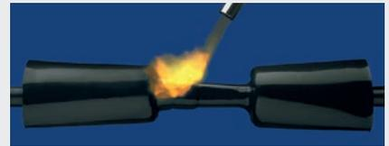
Zum Schluss wird die Außenmuffe positioniert und ebenfalls geschumpft. Auch hier sorgt der Heißschmelzkleber für eine zuverlässige Abdichtung zwischen Außenmuffe und Kabelaußenmantel.
