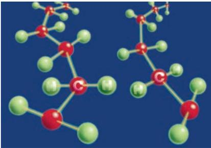
Thermoplaste bestehen aus sehr langen, kettenförmigen Molekülen. Dort, wo der Abstand zwischen den Molekülketten sehr gering ist, bilden sich kristalline Zonen. Diese kristallinen Zonen werden beim Erwärmen über den „kristallinen Schmelzpunkt“ aufgelöst. Bei Polyäthylen liegt diese Temperatur um  $+120^{\circ}\text{C}$ . Dies hat das Schmelzen und Fließen des Kunststoffes zur Folge.
