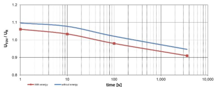
Temperatur der Prüflinge (vorerhitzt): 60°C nach IEC 60099-4, Ausg. 3.0 2014. Die Prüflinge wurden einem Blitzstoßstrom für 8/20 µs ausgesetzt bei einer Ladung von 0,55 C.
