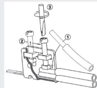
Bild 2 Montagereihenfolge mit Schiebeklemmen
