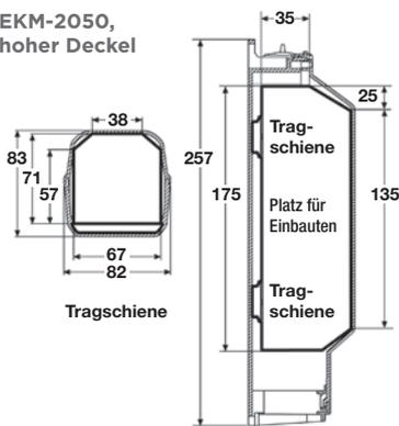
Positionsmöglichkeiten der Tragschiene
