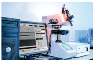
表面硬度是产品的一个重要参数。通过硬度计的硬度测量可以间接反应出产品的机械性能及热处理状态，是新产品选材验证及失效分析的有利工具。
