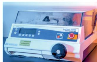
高精度切割机能精密地控制切片的位置和速度，为试验人员精确地在指定位置切开样品提供了保证。
