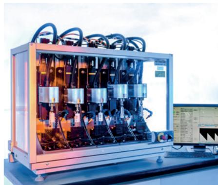
机械插拔循环装置能够模拟实际应用过程中的多次往复运动，同时还能监测产品在往复运动过程中的性能变化。
