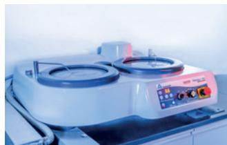
高精度研磨机对产品断面进行研磨，为试验人员获得光滑、清晰的实验产品断面提供了有力的保障。
