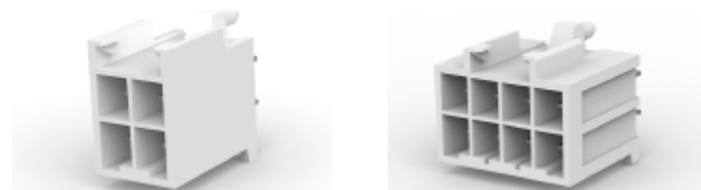
PDL ヘッダは、はんだ付け中に基板上のヘッダをしっかりと固定する取り付けボスのキンクと一緒に、はんだテールにキンクを与えます。基板に取り付けられたヘッダは樹脂またはコンフォーマルコーティングと互換性があります(排水孔は不要)。
