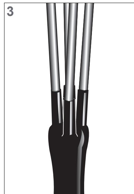
De installatie van het broekstuk is nu klaar. Laat het broekstuk afkoelen alvorens deze mechanisch te belasten.
