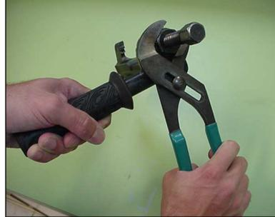
**Paso 5)** Utilice un alicates o herramienta similar para apretar el tornillo y finalizar el montaje.
