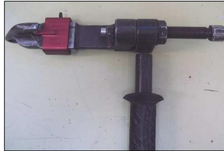
**Herramienta ensamblada para aplicación de conectores del Tipo Pequeño.**
