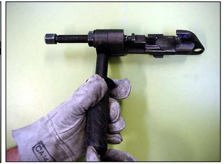
**Paso 1)** Posicione la grapa extractora, en la cabeza de retención, de modo que haga espacio para que el conector pueda ser acoplado a la herramienta.
