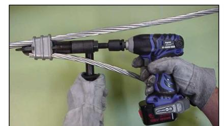
**Paso 6A)** Accione el gatillo de la herramienta eléctrica e empecé la aplicación. En promedio, el tiempo total de aplicación es de 20 segundos.
