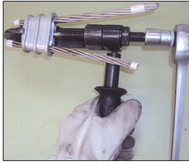
**Paso 5B)** Coloque el soquete apropiado para la aplicación (nº19 - mm) en la Llave Tipo Catraca y la acople al tornillo actuador.
