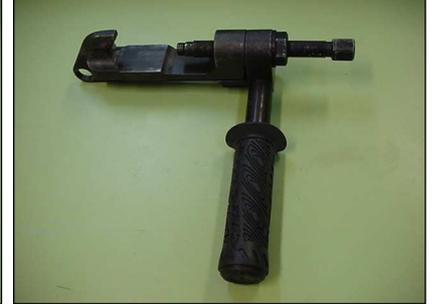
**Herramienta ensamblada para aplicación de conectores de los Tipos Medio I, II y III.**
