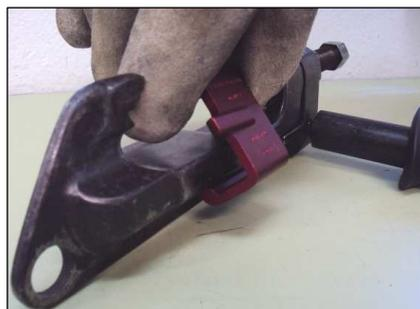
**Paso 2)** Enganche la plataforma auxiliar roja a la cabeza de retención de la herramienta de aplicación.
