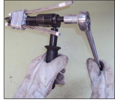
**Paso 6B)** Atornille, con la Llave Tipo Catraca, el tornillo actuador. En promedio, el tiempo total de aplicación es de 60 segundos.
