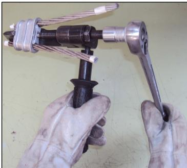
**Paso 9B)** Invierta el sentido de aprieto de la Llave Tipo Catraca, para retroceder el tornillo actuador y soltar el conector de la cabeza de retención.
