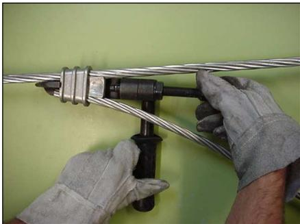
**Paso 1)** Retroceda el tornillo actuador para colocar el conector en la herramienta de aplicación.
