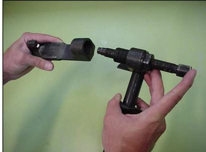
**Paso 4)** Posicione el módulo actuador y lo atornille a la cabeza de retención.
