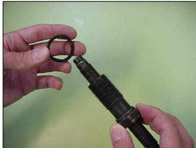
**Paso 2)** Acople la arandela al módulo actuador.
