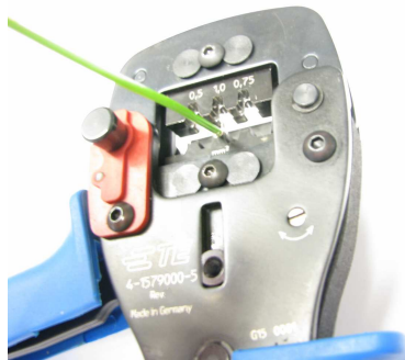
Abb. 4 : Einschieben von Leitung bis zum Drahtanschlag
