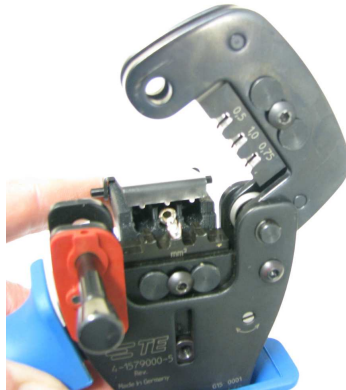
Abb. 3 : In unterer Crimpmatrize eingelegter Kontakt
