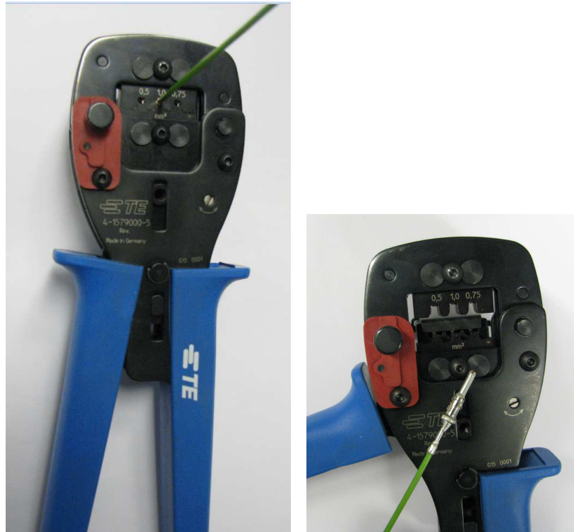
Abb. 5 : Zangengriffe komplett geschlossen (links), Prüfen des gecrimpten Kontaktes (rechts)
