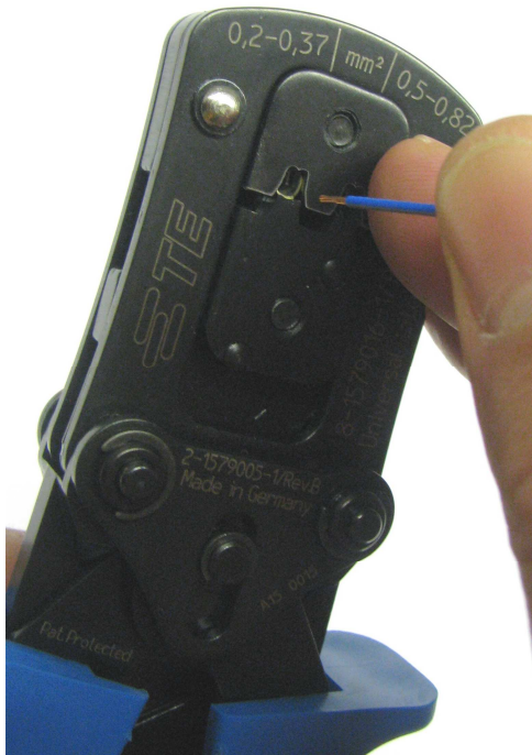
Abb. 6: Abisolierte Leitung in den Crimpbereich bis zum Anschlag einführen
