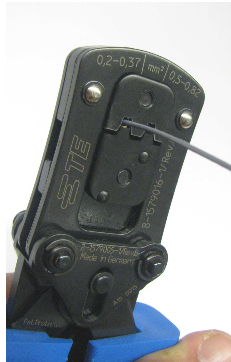
Abb. 7: Handzange schließen und Crimpen
