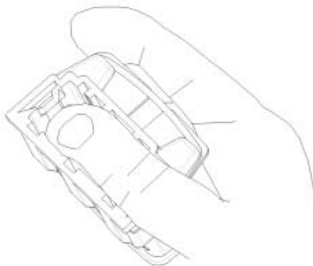
Figure 8 : Activation manuelle du verrou
