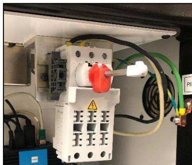
faites passer le câble par le haut. Raccordez le fil de terre au bornage de terre sur le cadre de la machine. Raccordez les câbles de phase à l'interrupteur d'isolement principal (voir Figure 11).
