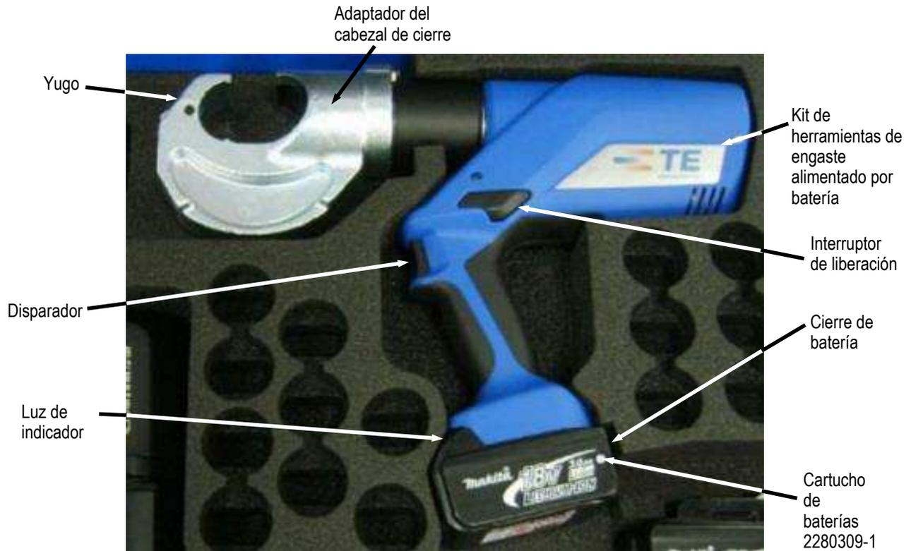
**HERRAMIENTA DE ENGASTE (con la batería instalada)**
