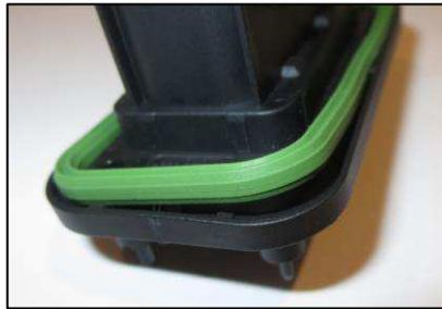
**Fig./Abb. 6:** Slipped out seal / herausgerutschte Dichtung
