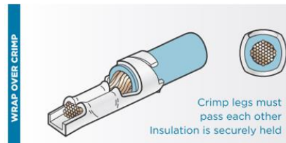
Figure 3.2 Insulation Crimp Type (Wrap) 图 3.2 绝缘压接类型（包裹型）
