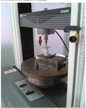
Foto: Ensaio de força de inserção.
