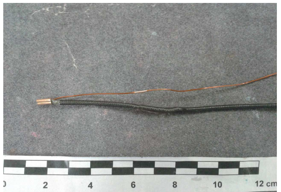
"B" Splice - MAG Copper 23 AWG + 0,75mm 2 wire.
