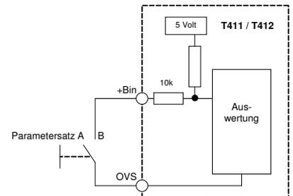
Ein Eingangswiderstand von 10kOhm verhindert, dass bei anliegen einer Spannung am Eingang +Bin und gleichzeitigem Betätigen des Tasters ein zu hoher Strom fliesst.
