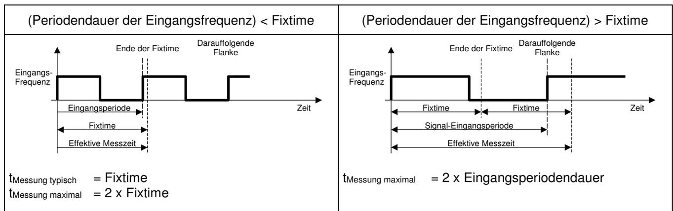
Die gesamte Messzeit wird mit einer Auflösung von  $\pm 0.4 \mu\text{s}$  berechnet.
