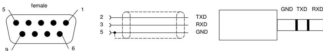
Den Anschlussplan des Stereo-Klinkensteckers zeigt die Anschlussbelegung der Schnittstelle. Der RXD des Tachometers muss mit dem TXD des PCs verbunden werden und umgekehrt. Die T411 / T412 Instrumente bilden nicht das Standard-RS 232-Signal (-5V ... +5V). RXD hingegen besitzt einen 5V-CMOS-Level, das mit den meisten PCs kompatibel ist, so lange das Kabel nicht länger als 2 Meter lang ist.
