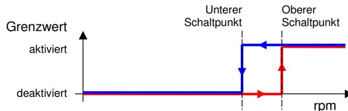
Beim hochfahren der Geschwindigkeit schaltet der Grenzwert beim Erreichen des <oberen Schaltpunkt>. Der Grenzwert hält dann den Zustand bis der <untere Schaltpunkt> wieder unterschritten wird.
