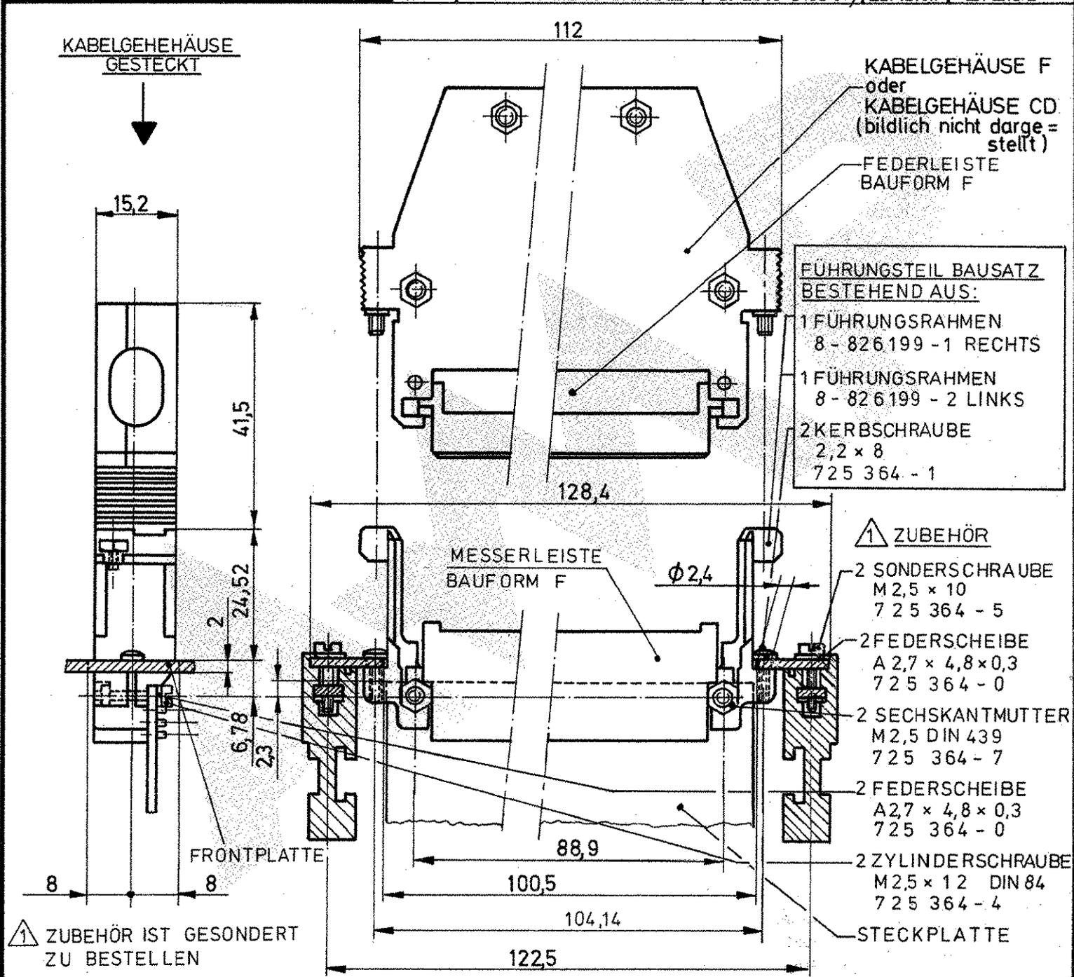
FRONTSEITE Für Messerleiste auf Leiterplatte montiert - mit Frontplatte
