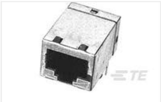
TE 产品编号1-1734580-1 MOD-Jack,RJ45, 10P10C, SHD LP, 6u" Au
