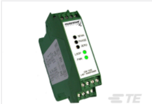
TE 产品编号02291333-000 LDM-1000 LVDT CONDITIONER DIN
