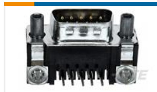
TE 产品编号5747842-6 25 MSFL PLUG RA 318 (SL,FM,BL)
