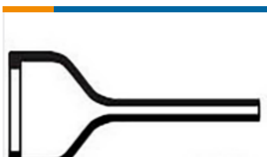
TE 产品编号556533-000 热缩护套：有嘴，直形
