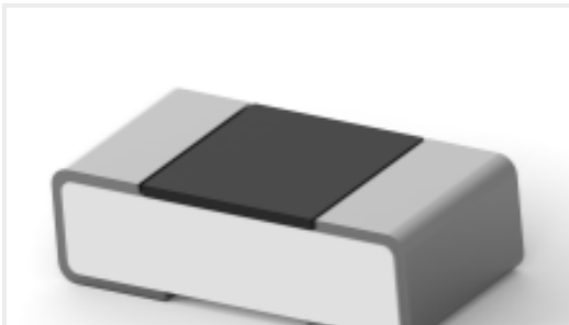
TE 产品编号6-2176363-3 RQ 0402 1K91 0.1% 10PPM 5K RL
