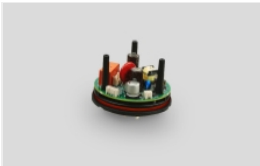
街道照明电源管理(6)
