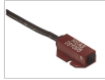
行人碰撞测试加速度传感器
