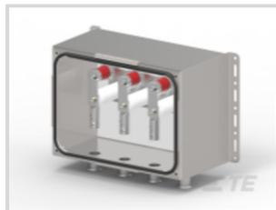
**我们的瑞侃 HVLB-SICO 单芯电缆高压接地箱用于电缆护套的接地和连接，可消除或减小感应电压和循环电流。**
