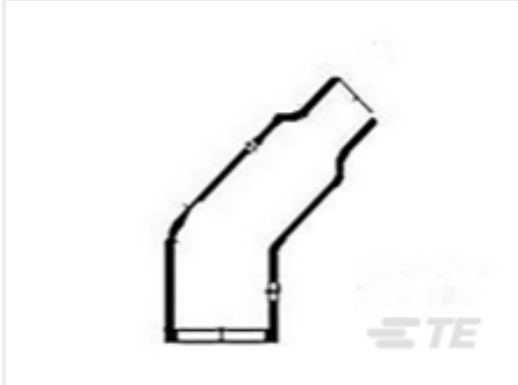
TE 产品编号 CAT-R21-731055422 热缩护套：聚合物成型，有嘴
