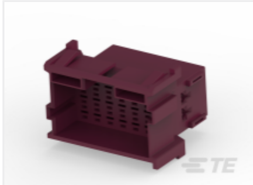
TE 产品编号4-2445760-1 21POS,2.8X0.8,TAB HSG,UNSLD,COD D
