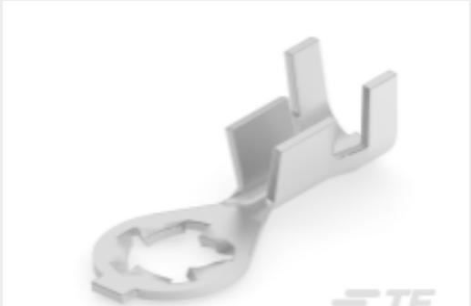
TE 产品编号2429931-2 RING,M4, DIA 4.3,14-18 AWG,TPBR
