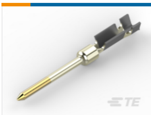
TE 产品编号 CAT-038-DCCPB22 D-Sub 连接器端子：针脚，黄铜，信号，22号
