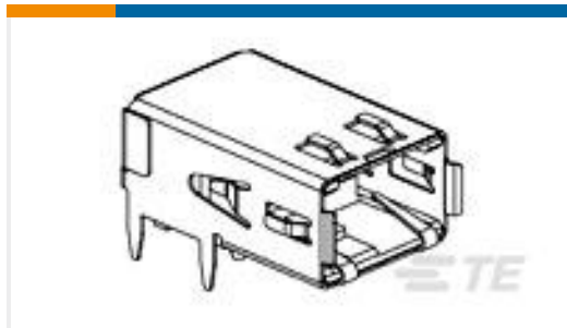
TE 产品编号1761072-3 RECPT,HSSDC2,FIBRE,TRAY PKG
