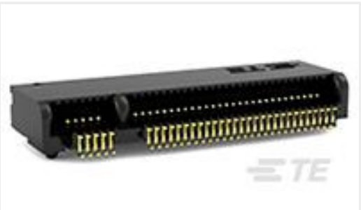
TE 产品编号1-2199119-5 M.2 0.5PITCH 3.2H KEY M 15U" AU
