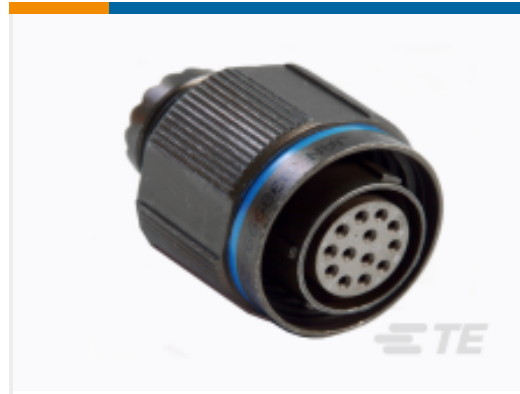
TE 产品编号YDTS26T15-19PNV001 D38999：直式插头，15-19 插件
