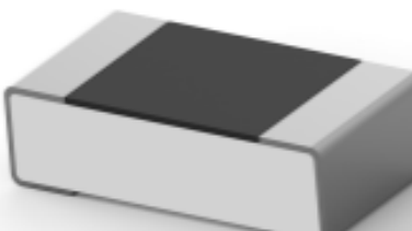
TE 产品编号3-2176372-0 RQ 0603 100K 0.1% 10PPM 5K RL
