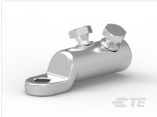
TE 产品编号CAT-BLMT 电压等级高达 84 kV 的力矩螺栓连接器
