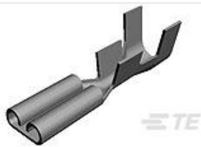
TE 产品编号62865-1 187 FASTON REC 20-16 AWG TPBR
