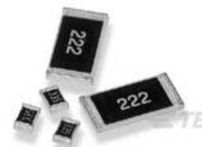
TE 产品编号 6-1879501-0 CRGH2512 5% 300R 2W
