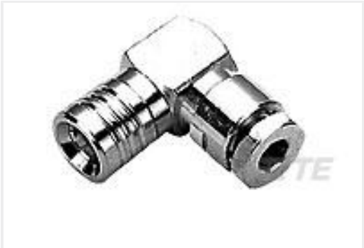
TE 产品编号1-1478008-0 SMB R/A Plg PS 50Ohn Gold Pltd RG174A/U,
