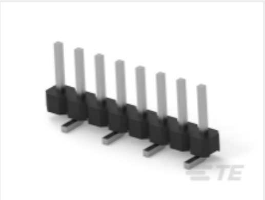
TE 产品编号2842104-8 8P,2MM,BRK HDR,SRVT,SMD,0.76AU, TR W/CAP
