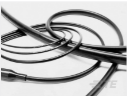
TE 产品编号CAT-R2137-RW200 单壁 RW 200：热缩管，2:1 收缩比
