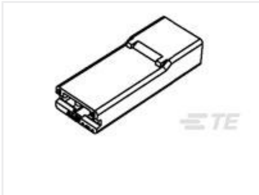
TE 产品编号1-735075-0 250 FASTON INS POST,REC.,1 POS
