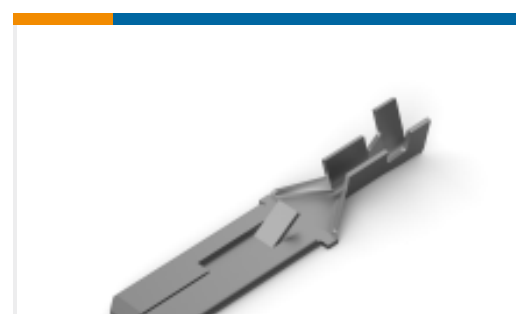
TE 产品编号880688-2 FF 250 TERMINAL 0.5-1.0MM2 0.39 X13.2TPBR
