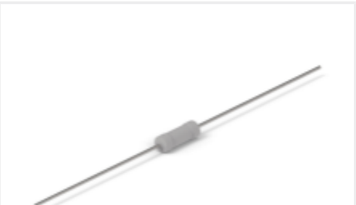
TE 产品编号7-1676123-7 1/2W SM M/OX 5% 1K2
