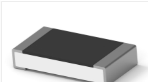
TE 产品编号1-2176391-0 RQ 1206 15K4 0.1% 10PPM 5K RL
