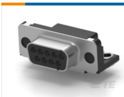
TE 产品编号5747844-5 D-Sub 插座组件：直角，外壳尺寸 1， 2.74mm
