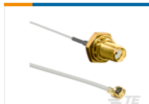
TE 产品编号CSI-SGFI-200-UFFR SMA to U.FL/MHF1 200mm 1.13 OD
