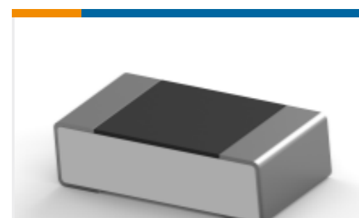
TE 产品编号9-2176370-4 RQ 0603 4K02 0.1% 10PPM 5K RL
