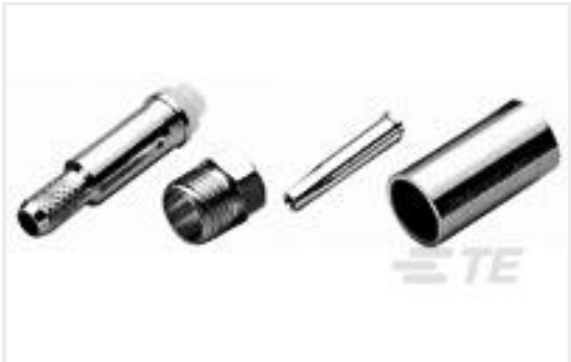
TE 产品编号1-1337552-0 FME Str Jk Hex Nickel Pltd RG58C/U, 141A
